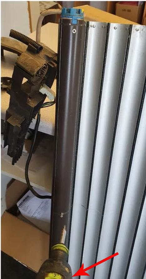
Um den Motor nun aus der Rollladenwelle zu bekommen, muß der Panzer (die Lamellen) komplett abgewickelt werden, um anschliessend mit roten Pfeil markierte Schraube lösen zu können.
