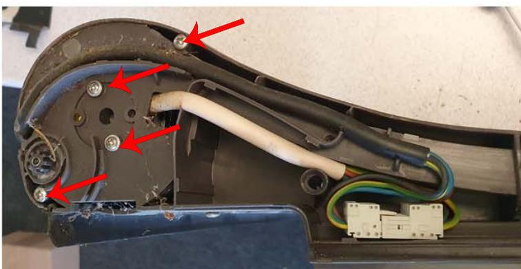
Schrauben lösen, um den weiteren
