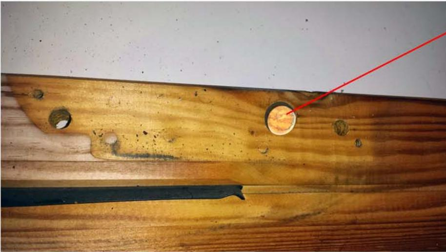
Am Grundrahmen fehlt die vom Werk vorgefertigte Ausstanzung für den Pressknopf, damit dieser nach Innen gedrückt werden kann
