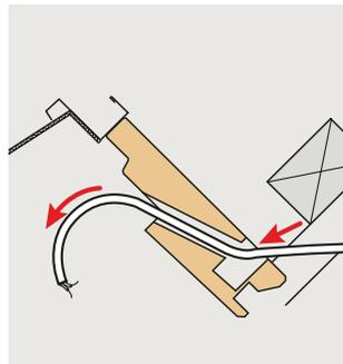
Die Leitung durch das Loch im Blendrahmen-Oberteil und weiter durch das Isoliermaterial führen.
