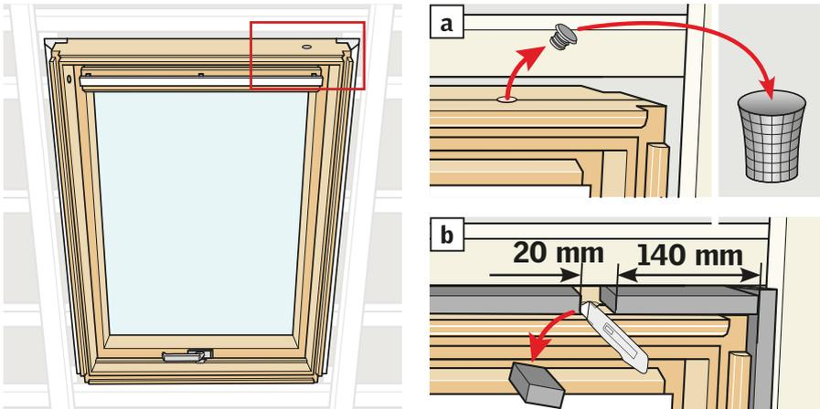
Abdeckkappe entfernen (a). Falls ein Dämm- und Anschluss-Set BDx um das Fenster montiert ist, das Isoliermaterial an der Abdeckkappe wegschneiden (b). Das weggeschnittene Isoliermaterial muss nach Abschluss der Leitungsführung wieder eingesetzt werden.
