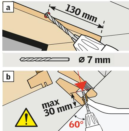
Loch für Leitungsführung zwischen Blendrahmen-Oberteil und Innenfutter bohren (a).
