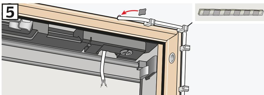
Das Kabel so ziehen, dass ein Einklemmen des Kabels zwischen dem Isoliermaterial und dem Blendrahmen-Oberteil vermieden wird. Dichtungsmaterial auf das Loch kleben. Die Leitung am Innenfutter befestigen.
