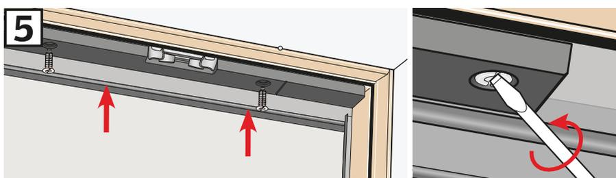
Das Isoliermaterial in den Blendrahmen-Oberteil einsetzen.
