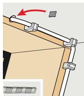
Die Leitung durch das Loch im Blendrahmen-Oberteil und weiter durch das Loch im Fensterflügel führen. Eventuell vorhandene Abdeckkappe im Fensterflügel entfernen. Die Leitung kürzen, so dass ca. 200 mm Leitung zurückbleibt. Dichtungsmaterial auf das Loch kleben. Die Leitung am Innenfutter befestigen.
