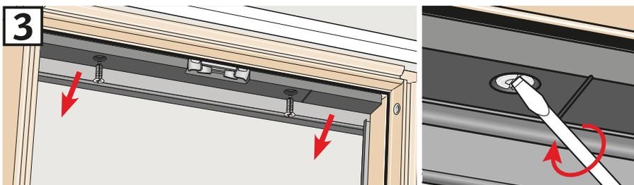
Das Isoliermaterial im Blendrahmen-Oberteil mit einem Schraubendreher entfernen.
