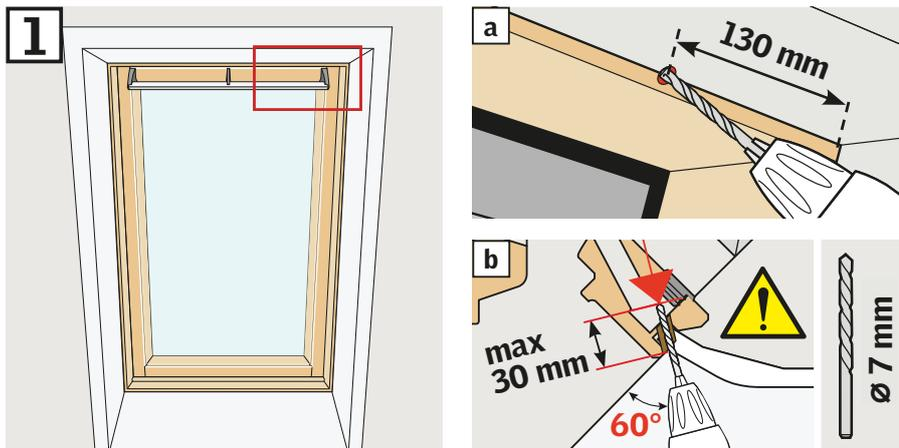
Loch für Leitungsführung zwischen Blendrahmen-Oberteil und Innenfutter bohren (a).
