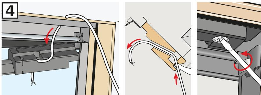
Die Leitung durch das Loch im Blendrahmen-Oberteil und weiter durch das Isoliermaterial führen. Das Isoliermaterial in den Blendrahmen-Oberteil einsetzen.
