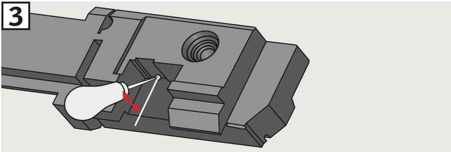
Um Platz für das Kabel zu schaffen, wird in dem dargestellten Bereich mit einer Ahle ein Loch im Isoliermaterial durchgestoßen.
