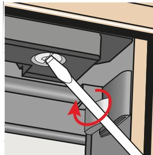
Das Isoliermaterial im Blendrahmen-Oberteil mit einem Schraubendreher entfernen.
