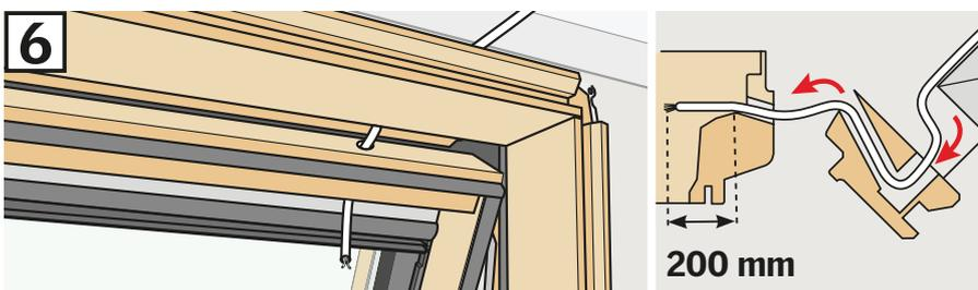
Die Leitung durch das Loch im Blendrahmen-Oberteil und weiter durch das Loch im Fensterflügel führen. Eventuell vorhandene Abdeckkappe im Fensterflügel entfernen. Die Leitung kürzen, so dass ca. 200 mm Leitung zurückbleibt.
