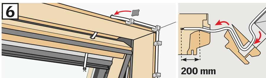
Die Leitung durch das Loch im Blendrahmen-Oberteil und weiter durch das Loch im Fensterflügel führen. Eventuell vorhandene Abdeckkappe im Fensterflügel entfernen. Die Leitung kürzen, so dass ca. 200 mm Leitung zurückbleibt. Dichtungsmaterial auf das Loch kleben. Die Leitung am Innenfutter befestigen.
