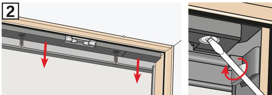
Das Isoliermaterial im Blendrahmen-Oberteil mit einem Schraubendreher entfernen.
