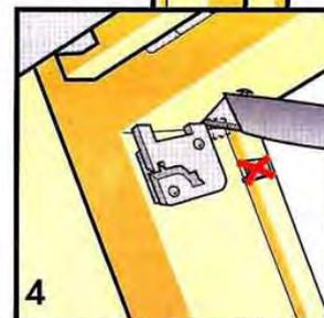
Vor der Montage der Zubehörträger die rot markierten Zapfen abschneiden (1). Träger wie dargestellt am Fenster anbringen (2): Träger mit Schlitz oben links, mit Loch oben rechts montieren (3). Zubehörträger müssen hinten an der Gasträgerleiste anliegen, Distanzstück der Träger auf beiden Seiten entfernen (4).
