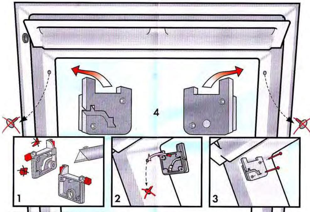
Vor der Montage der Zubehörträger, die rot markierten Teile abschneiden (1). Weiße Abdeckkappen oben links und rechts entfernen, Zapfen der Zubehörträger im Loch platzieren (2) und Zubehörträger mit Nägeln befestigen (3). Träger mit Schlitz oben links, mit Loch oben rechts montieren (4).
