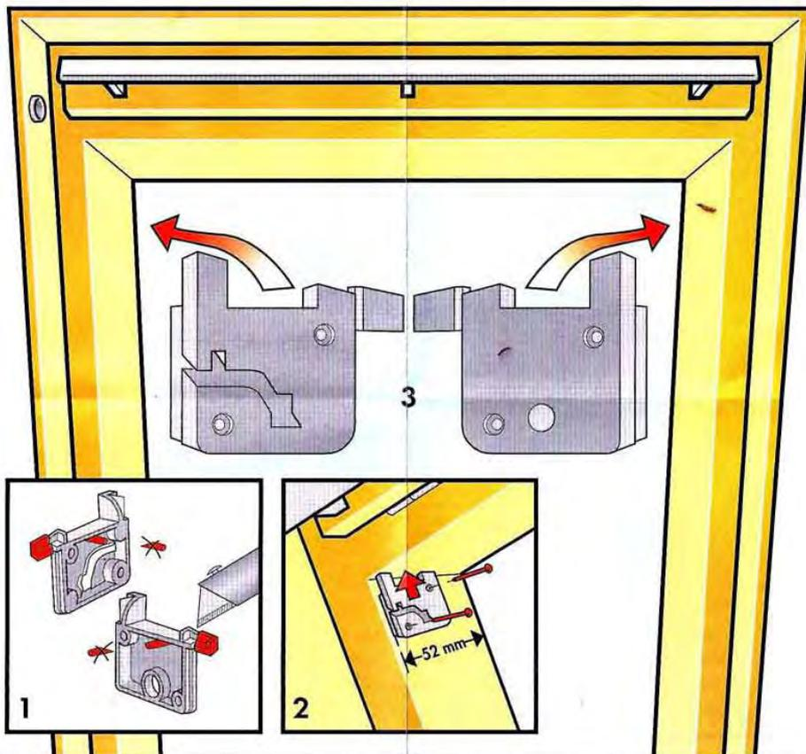
Vor der Montage der Zubehörträger die rot markierten Teile abschneiden (1). Träger wie dargestellt am Fenster anbringen: 52 mm Abstand unbedingt einhalten (2)! Träger mit Schlitz oben links, mit Loch oben rechts montieren (3).
