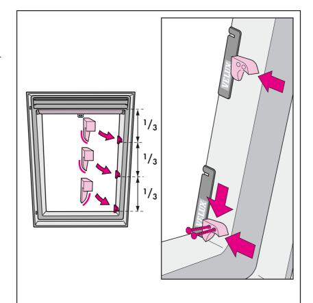
Rollo nach unten ziehen, nacheinander in die bereits auf der einen Seite montierten Haltekrallen einhängen und die Position der gegenüberliegenden Haltekrallen anzeichnen.
