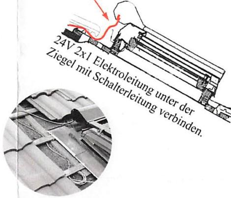
Kabel unter dem **oberen** Ziegel durchführen!
